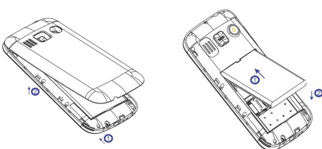
Установку SIM-карт необходимо производить в предназначенные для них слоты так, чтобы угловой срез SIM-карты совпадал с инструкцией по установке SIM на корпусе телефона.
